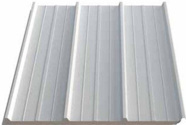
Pannello metallico autoportante coibentato con schiuma poliuretano indicato per la realizzazione di coperture di fabbricati industriali e civili con pendenza superiore al 7%. Il lato esterno del pannello è costituito da un supporto metallico grecato in acciaio zincato e preverniciato. L'isolamento termico in poliuretano espanso può avere uno spessore fuori greca  $S$  da 30 a 120 mm. Il supporto interno è realizzato in lamiera di acciaio zincato e preverniciato.
