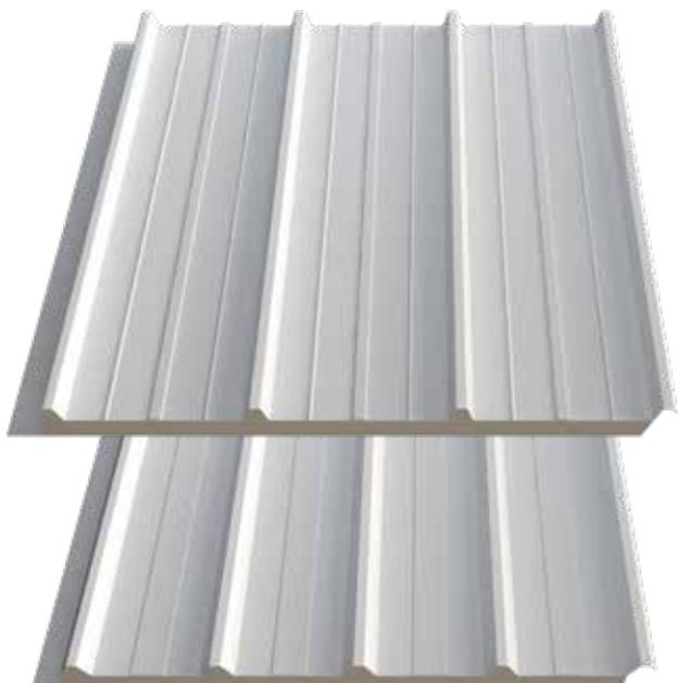
Pannello metallico autoportante coibentato con poliuretano espanso, indicato per la realizzazione di coperture di fabbricati civili e industriali con pendenza superiore al 7%.
