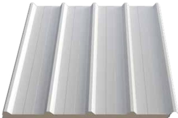
Pannello metallico autoportante coibentato con schiuma poliuretamica indicato per la realizzazione di coperture di fabbricati industriali e civili con pendenza superiore al 7%. Il lato esterno del pannello è costituito da un supporto metallico grecato in acciaio zincato e preverniciato. L'isolamento termico in poliuretano espanso può avere uno spessore fuori greca  $S$  da 30 a 100 mm. Il supporto interno è realizzato in lamiera di acciaio zincato e preverniciato.
