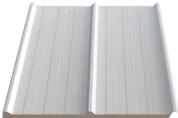
Pannello metallico autoportante coibentato con schiuma poliuretanicata indicato per la realizzazione di coperture di fabbricati industriali e civili con pendenza superiore al 7%. Il lato esterno del pannello è formato da un supporto metallico grecato in acciaio zincato e preverniciato. L'isolamento termico in poliuretano espanso può avere uno spessore fuori greca  $S$  da 30 a 100 mm. Il supporto interno è realizzato in lamiera di acciaio zincato e preverniciato.
