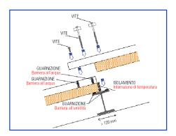
METECNO ITALIA consiglia di richiedere la predisposizione per lo sporto di gronda (end-lapping) allo scopo di realizzare un gocciolatoio e di evitare eventuali infiltrazioni nell'isolante o all'interno dell'edificio.
