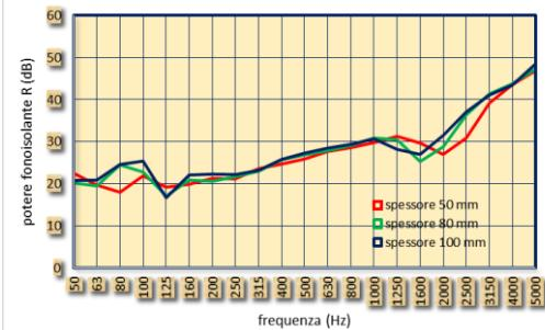
Su richiesta possono essere forniti i rapporti di prova delle misure del potere fono isolante per le frequenze di suono comprese fra 50 e 5000 Hz
