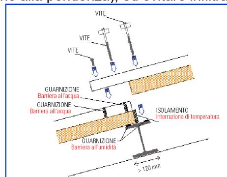
METECNO consiglia di richiedere la predisposizione per lo sporto di gronda (end-lapping) allo scopo di realizzare un gocciolatoio e di evitare eventuali infiltrazioni nell'isolante o all'interno dell'edificio.
